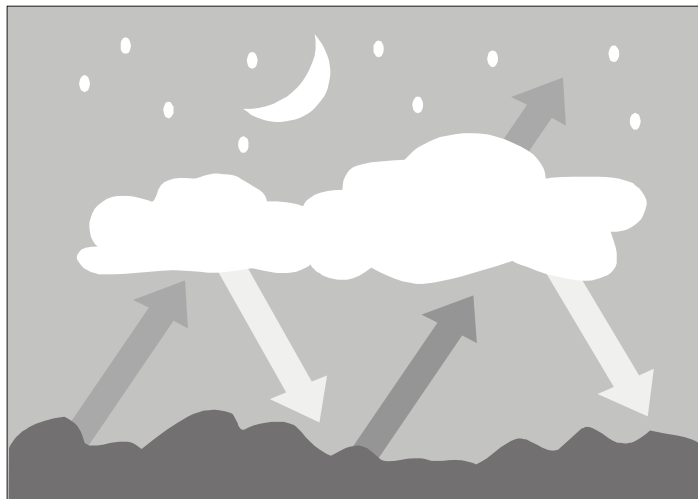
Figura 2. Las nubes reintegran calor a la tierra y disminuye la ocurrencia de heladas
