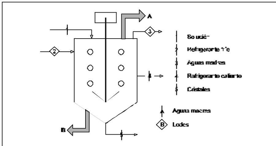
Los aparatos usados en esta operación se llaman cristalizadores. El principal objetivo de un cristizador es, primero, crear una solución sobresaturada, y luego fomentar la creación y el crecimiento de los cristales. Las aguas madres del proceso y los líquidos residuales originados durante la limpieza de los equipos son los residuos que se generan de esta operación unitaria (Ver figura 1.5).
