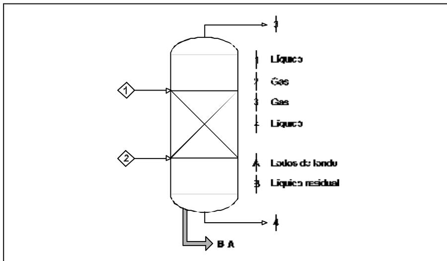
Las torres de etapas son columnas cilíndricas que contienen en su interior una serie de platos perforados o con campanas de burbujeo que permiten el contacto íntimo de las fases líquida y gaseosa.
