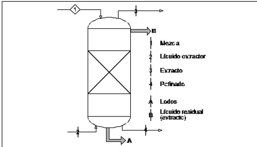
La extracción líquido-líquido es una operación unitaria que consiste en poner una mezcla líquida en contacto con un segundo líquido miscible, que selectivamente extrae uno o más de los componentes de la mezcla. Se emplea en la refinación de aceites lubricantes y de disolventes, en la extracción de productos que contienen azufre y en la obtención de ceras parafínicas.
